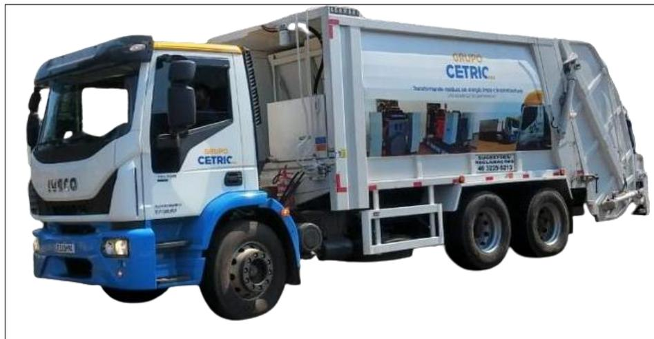
Figura 2: Caminhão coletor tipo compactador utilizado nos serviços de coleta convencional de RSU.
